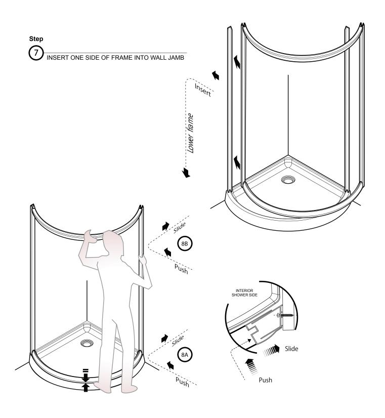
8 ENGAGE THE OTHER SIDE OF FRAME INTO WALL JAMB
